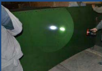
INSPECCION FINAL VISUAL DEL ACABADO DEL RECUBRIMIENTO ANTES DE EMPAQUE, MARCADO CON STICKER SERIAL DEL LOTE Y POSICION DE LA LAMINA EN EL TANQUE, RECUBRIMIENTO CON ESPUMA DE POLIETILENO, PARA PROTECCION DE CADA LAMINA, ARMADO DE LAS LAMINAS EMPACADAS SOBRE EL SKID DE TRANSPORTE DE MADERA Y RECUBRIMIENTO TOTAL DEL EMBARQUE CON SUNCHO FINAL. LUEGO SE CONSTRUYE UN CAJON DE MADERA PARA EL EMBARQUE FINAL HACIA EL SITIO DE INSTALACION
