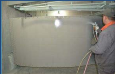
RECUBRIMIENTO MORTERO BASE A VITRIFICAR INCOLORO, SECADO, FUSION A 880-900 °C DE 8 A 20 MIN, ENFRIADO, RECUBRIMIENTO CON MORTERO CON COLOR DE ACABADO FINAL, SECADO Y VITRIFICADO A 800-820°C POR 6 A 16 MIN. SI REQUIERE ACABADO BLANCO INTERIOR SE APLICA UNA CAPA ADICIONAL CON PIGMENTO BLANCO, SE SECA Y SE FUNDE A 780-800°C. DESPUES DE CADA SECADO SE INSPECCIONA EL ACABADO ANTES DE VITRIFICAR
