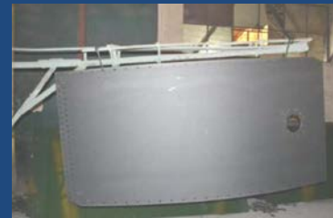
GRANALLADO CON ESFERAS EN ACERO INOXIDABLE HASTA ALCANZAR METAL BLANCO
