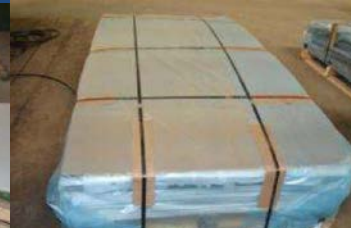
INSPECCION FINAL VISUAL DEL ACABADO DEL RECUBRIMIENTO ANTES DE EMPAQUE, MARCADO CON STICKER SERIAL DEL LOTE Y POSICION DE LA LAMINA EN EL TANQUE, RECUBRIMIENTO CON ESPUMA DE POLIETILENO, PARA PROTECCION DE CADA LAMINA, ARMADO DE LAS LAMINAS EMPACADAS SOBRE EL SKID DE TRANSPORTE DE MADERA Y RECUBRIMIENTO TOTAL DEL EMBARQUE CON SUNCHO FINAL. LUEGO SE CONSTRUYE UN CAJON DE MADERA PARA EL EMBARQUE FINAL HACIA EL SITIO DE INSTALACION
