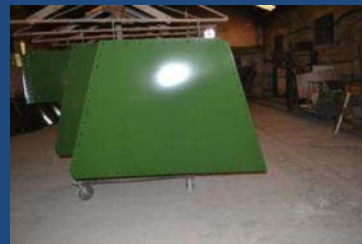
INSPECCION VISUAL DEL ACABADO DEL RECUBRIMIENTO, TEST DE HOLLIDAY A 1500 V, TEST DE ESPESOR DEL RECUBRIMIENTO Y TEST A UNA MUESTRA DEL MATERIAL PARA ATAQUE CON ACIDO Y ALCALI, TEST DE ADHESION DEL RECUBRIMIENTO Y TEST DE ESTABILIDAD DE UNA MUESTRA A ALTA TEMPERATURA.
