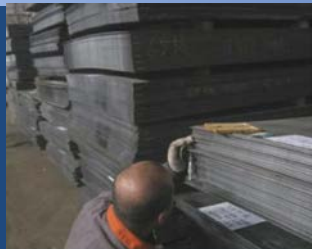
RECEPCION DEL MATERIAL Y VERIFICACION DEL ESPESOR
