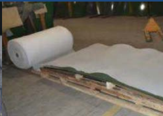
INSPECCION FINAL VISUAL DEL ACABADO DEL RECUBRIMIENTO ANTES DE EMPAQUE, MARCADO CON STICKER SERIAL DEL LOTE Y POSICION DE LA LAMINA EN EL TANQUE, RECUBRIMIENTO CON ESPUMA DE POLIETILENO, PARA PROTECCION DE CADA LAMINA, ARMADO DE LAS LAMINAS EMPACADAS SOBRE EL SKID DE TRANSPORTE DE MADERA Y RECUBRIMIENTO TOTAL DEL EMBARQUE CON SUNCHO FINAL. LUEGO SE CONSTRUYE UN CAJON DE MADERA PARA EL EMBARQUE FINAL HACIA EL SITIO DE INSTALACION
