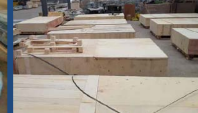
INSPECCION FINAL VISUAL DEL ACABADO DEL RECUBRIMIENTO ANTES DE EMPAQUE, MARCADO CON STICKER SERIAL DEL LOTE Y POSICION DE LA LAMINA EN EL TANQUE, RECUBRIMIENTO CON ESPUMA DE POLIETILENO, PARA PROTECCION DE CADA LAMINA, ARMADO DE LAS LAMINAS EMPACADAS SOBRE EL SKID DE TRANSPORTE DE MADERA Y RECUBRIMIENTO TOTAL DEL EMBARQUE CON SUNCHO FINAL. LUEGO SE CONSTRUYE UN CAJON DE MADERA PARA EL EMBARQUE FINAL HACIA EL SITIO DE INSTALACION
