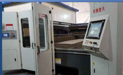
CORTE, PONCHADO LASER Y CURVADO DE LAMINAS, REDONDEO DE BORDES Y VERIFICACION DE CORRECTO POSICIONAMIENTO DE ORIFICIOS Y DE ARCO DE CURVADO DE LAMINAS
