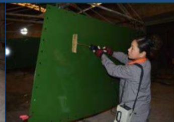
INSPECCION VISUAL DEL ACABADO DEL RECUBRIMIENTO, TEST DE HOLLIDAY A 1500 V, TEST DE ESPESOR DEL RECUBRIMIENTO Y TEST A UNA MUESTRA DEL MATERIAL PARA ATAQUE CON ACIDO Y ALCALI, TEST DE ADHESION DEL RECUBRIMIENTO Y TEST DE ESTABILIDAD DE UNA MUESTRA A ALTA TEMPERATURA.
