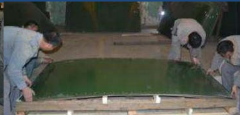
INSPECCION FINAL VISUAL DEL ACABADO DEL RECUBRIMIENTO ANTES DE EMPAQUE, MARCADO CON STICKER SERIAL DEL LOTE Y POSICION DE LA LAMINA EN EL TANQUE, RECUBRIMIENTO CON ESPUMA DE POLIETILENO, PARA PROTECCION DE CADA LAMINA, ARMADO DE LAS LAMINAS EMPACADAS SOBRE EL SKID DE TRANSPORTE DE MADERA Y RECUBRIMIENTO TOTAL DEL EMBARQUE CON SUNCHO FINAL. LUEGO SE CONSTRUYE UN CAJON DE MADERA PARA EL EMBARQUE FINAL HACIA EL SITIO DE INSTALACION
