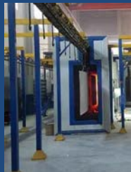
RECUBRIMIENTO MORTERO BASE A VITRIFICAR INCOLORO, SECADO, FUSION A 880-900 °C DE 8 A 20 MIN, ENFRIADO, RECUBRIMIENTO CON MORTERO CON COLOR DE ACABADO FINAL, SECADO Y VITRIFICADO A 800-820°C POR 6 A 16 MIN. SI REQUIERE ACABADO BLANCO INTERIOR SE APLICA UNA CAPA ADICIONAL CON PIGMENTO BLANCO, SE SECA Y SE FUNDE A 780-800°C. DESPUES DE CADA SECADO SE INSPECCIONA EL ACABADO ANTES DE VITRIFICAR
